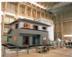
実物大のモデル住宅に阪神大震災と全く同じ地震波形を与える実験を行い、震度7の揺れを複数回与える耐震実験をクリアしています。
